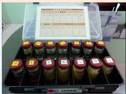
Bộ kit đào tạo về phân loại và kiểm tra độ nhớt dầu mỡ
