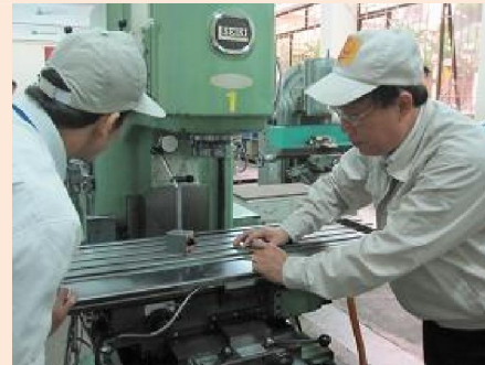
Thực hành kiểm tra độ đảo mặt đầu và độ đảo hướng kính của trục chính máy phay
