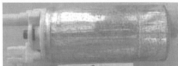
Hình 2. Vỏ bơm nhiên liệu trước và sau khi ngâm E20
