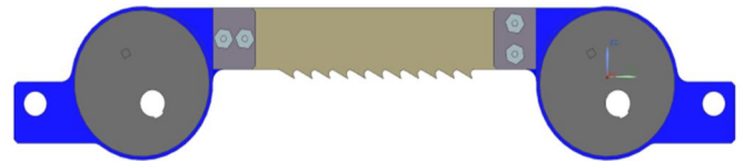
Hình 8. Phương án thiết kế mô đun cưa hợp lý tìm được dựa vào mô hình toán
