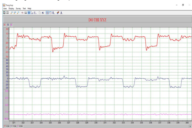
Hình 11 Lực cắt đo được khi phay mặt cầu lõm với lượng dư t = 0,2 , bước dịch dao ngang s = 0,1 và ở góc \varphi = 80^\circ
